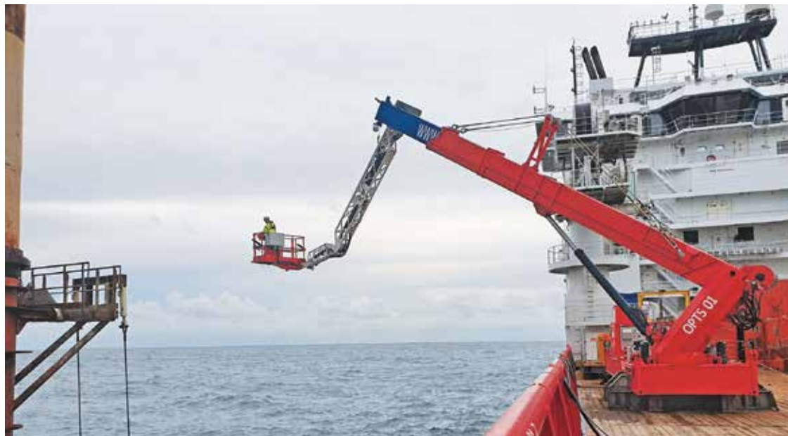
Das OPTS-System umfasst eine multifunktionale hydraulische Hebebühne für den Transport von Personen und Material.
