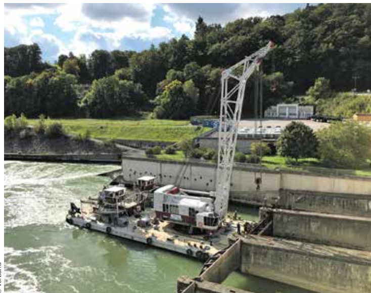
DOKW 2 Dieser Verbund-eigene Schwimmkran kann Lasten bis zu 80 Tonnen transportieren, ist ein Unikat auf der Donau und platziert die Dammbalken.
