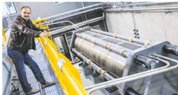
Projektleiter Ewald Perwög vor dem Herzstück der Anlage, dem Elektrolyseur. In diesem wird Wasser in Wasser- und Sauerstoff zerlegt.
